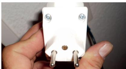
Entfernter Kontaktstift bei dreipoligem Stecker.
